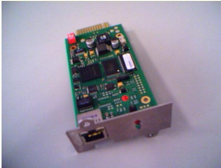
Abbildung 1-1 CS 121 SNMP Einbaumodul
