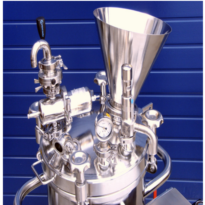
Abb. 3: Pharmabehälter 25 Liter für Entwicklungsabteilung mit Produkt-einfülltrichter und klappbarem Behälterdeckel und Anschlüssen für alle Medien. Geschliffen und elektropoliert.
