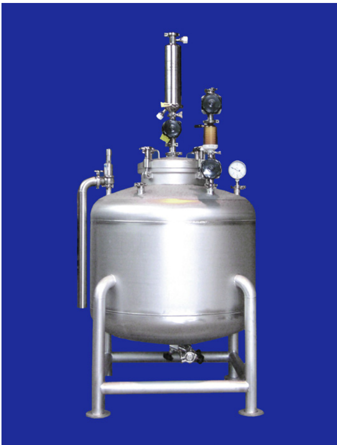
Abb. 15: Einfacher Transportbehälter für sterile Augentropfen vom Hersteller zur Abfüllanlage. Mit Sicherheitseinrichtung, Sterilfilter mit Integritätstestanschlüssen und Produktfilter. Behälter aus 1.4435, innen elektropoliert, aussen gebeizt, aber nicht verschliffen.
