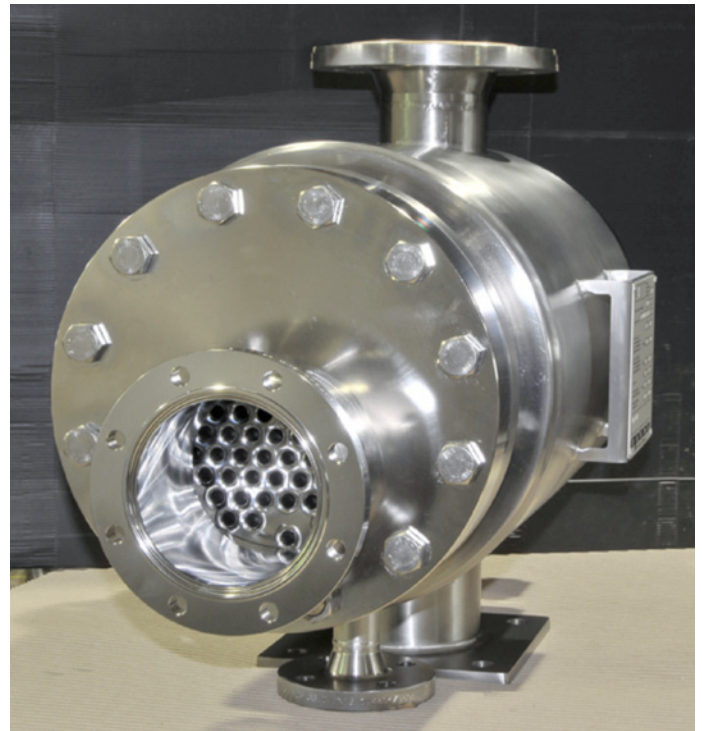
Abb. 5: Pharmawärmetauscher mit Steriflanschanschluss. Vollständig entleerbar mit vollverschweisstem Isolationsmantel zur Aufheizung von WFI. Mit Schwarzdampf und Kondensatanschluss.
