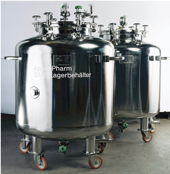
Abb. 2: Mobile Transportbehälter für die Andockung an ein Kippsystem. Zur Herstellung von halbfesten Darreichungsformen im Reinraum.
