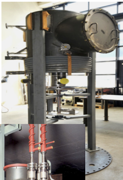
Abb. 5: Pharmawärmetauscher mit Steriflanschanschluss. Vollständig entleerbar mit vollverschweisstem Isolationsmantel zur Aufheizung von WFI. Mit Schwarzdampf und Kondensatanschluss.
