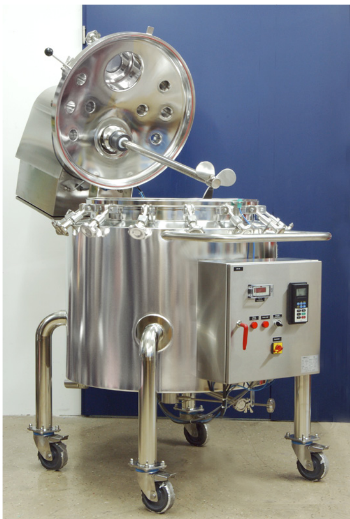
Abb. 12: Mobiler Ansatzbehälter 250 Liter mit Steuerung und integriertem Rührwerk. Rührmotor frequenzgesteuert. Die Abdichtung der Rührwerks-welle erfolgt mit einer gasgeschmierten Gleitringdichtung, um eine Verunreinigung des hochsensiblen Produktes zu verhindern.
