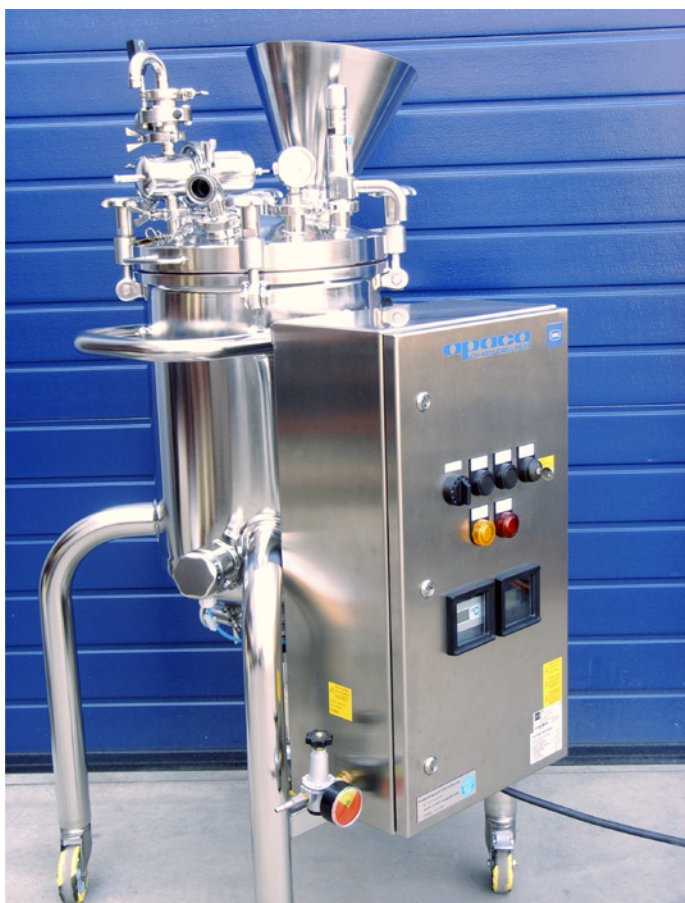
Abb. 8: Mobiler Ansatzbehälter 60 Liter mit Dispergator für Lösungsmittel und Pulver. Behälter innen Zone 0/20, Gerätekategorie 1 G/1D und aussen Zone 1/21, Gerätekategorie 2 G/2 D. Dispergator mit doppelter Sicherheitsüberwachung. Anlage mit EG Baumusterprüfung.
