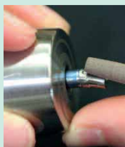
Fräsen mit einer 2-Grad-Abutmentfräse von Komet
