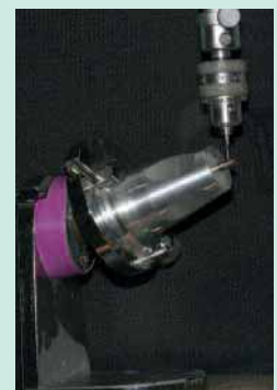
Anlegen einer Verschraubung mit einem 90-Grad-abgewinkelten Modelltisch
