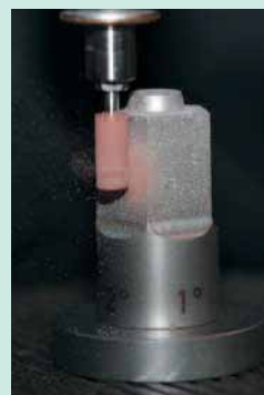
Abrichten des Gummipolierers mit Abrichtset 446 Komet
