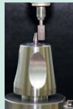
Glätten des Abutments mit Frästechnikpolierer 9440C/M/F123.060
