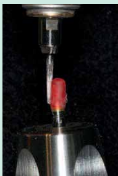
Vorbereiten mit 2-Grad-Konusfräse
