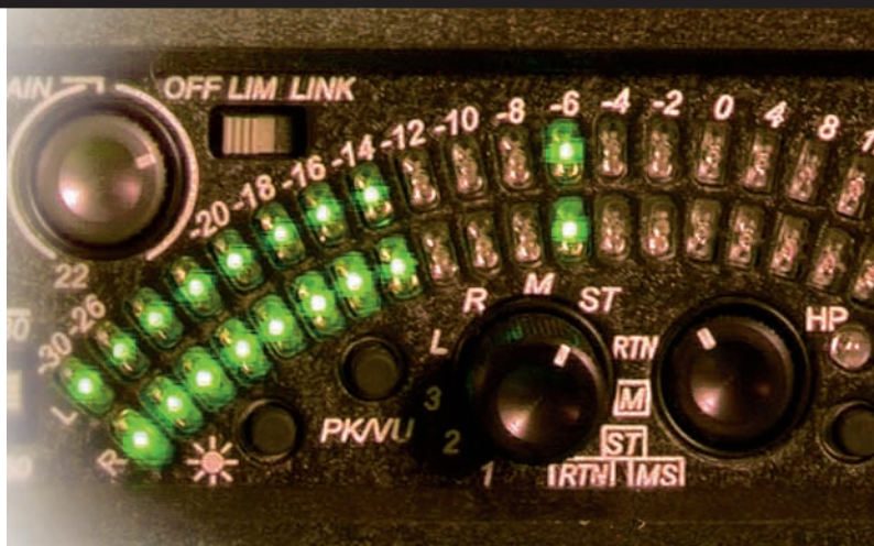
Umschaltbare Pegelanzeige und Setup in einem – beim Sound Devices 302.
