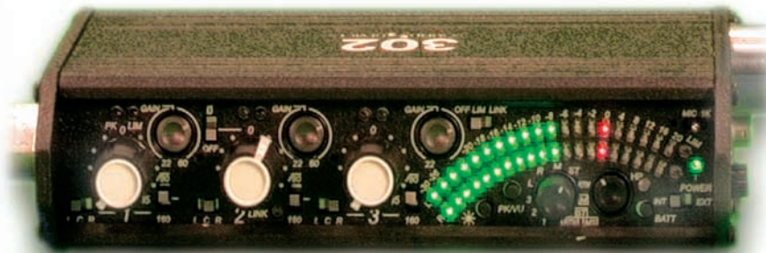
Sound Devices: Tribut an die kompakte Bauweise sind die schwer zugänglichen Schalter zwischen den Reglern und der fummelige Anschluss der externen Stromversorgung.
