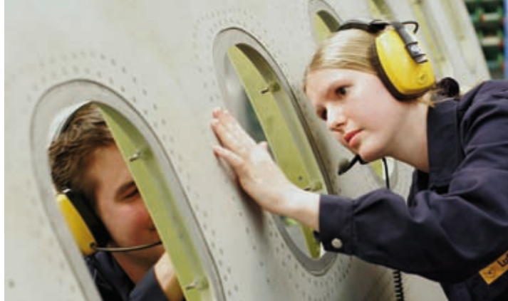
Ausbildung: Kontrolle von Nietarbeiten am Übungsrumpf der Lufthansa Technik
