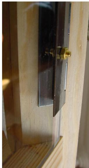
Noch ein Tipp: Um das 45 Grad Türelement zu bauen ist es hilfreich die rechte und linke Rahmenleiste an das Regalgerüst zu klemmen (Schraubzwinde), und dann erst mit den Spannbändern die Querstreben zu fixieren, unter zu Hilfenahme des Eckpfostens. Siehe auch folgendes Bild:
