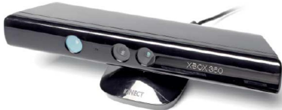
Die Kinect dient längst nicht mehr nur zur Bewegungssteuerung, sondern kommt zur Objekterfassung in der Robotik und als 3D-Scanner zum Einsatz. Der Asus-Kamera fehlt die Motorsteuerung, dafür ist sie kompakter und braucht kein zusätzliches Netzteil.
