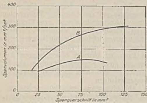
Abb. 5. Leistungsversuche mit zwei Meißelhämmern A und B.
