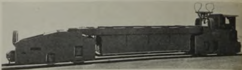
Abb. 6. Elektrische Grubenlokomotive für gemischten Betrieb.
