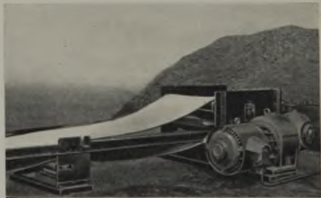
Abb. 4. Förderbandanlage mit Vorgelegemotor.
