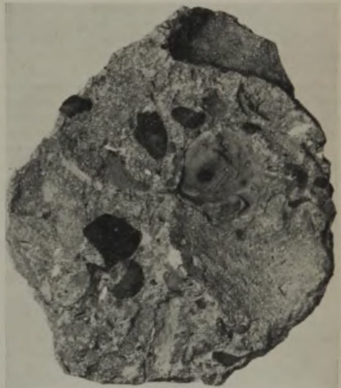
Abb. 2. Rote Toneisensteingerölle (dunkle Stellen) im Zechsteinkonglomerat auf der Zeche Rheinpreußen. Nat. Gr.
