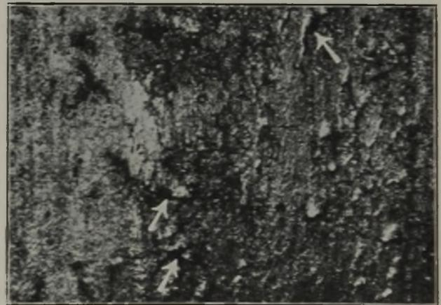
Abbildung 2. Risse in der kaltverformten Laufzone. (× 20)
