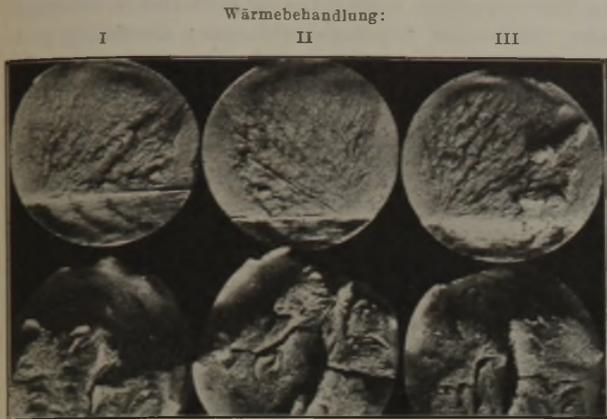
Bild 1. Härtebruchgefüge (oben) und Vergütungsbruchgefüge (unten) von Stahl St C 35.61 bei 60 mm Dmr.
