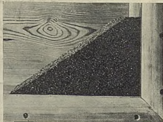
Abb. 11. Natürliche Böschung von ausgesiebtem Sand in Ruhelage (Korngröße 0,9 bis 1,2 mm).
