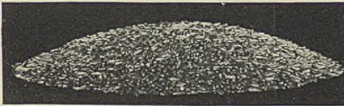
Abb. 8. Roggenhaufen nach andauernder Erschütterung der Unterlage.
