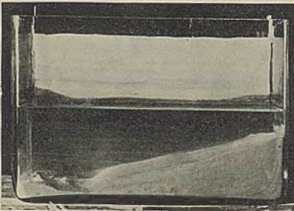
Abb. 18. Schlammige Ablagerung feiner Tonerde unter Wasser, einseitig vorsichtig eingestreut.
