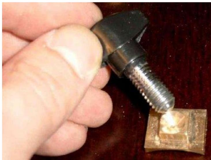
In die Bremsblöcke habe ich mit der Bohrmaschine und normalem HSS-Bohrer Kegelsenkungen eingebohrt, die die Blöcke auf den Fixierschrauben führen sollen.
