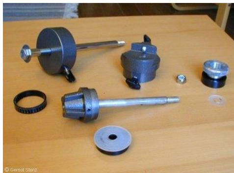
Bei besagten Blöcken sollte es sich um die schwarzen Kunststoffringe der beiden Achsen handeln, die bei zu beherztem Anziehen der Fixierschrauben durchreißen, oder gar in mehrere Teile zerfallen können.
