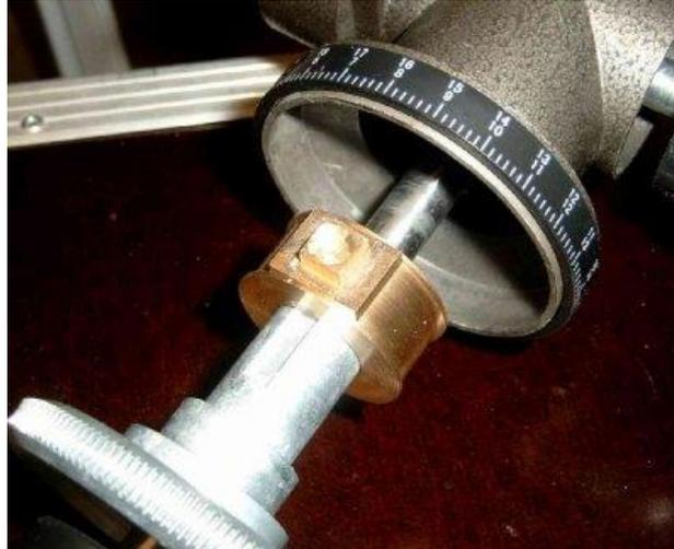
Die beiden Achsen, sowie die angefertigten Messingscheiben haben eine DIN-Einpassung, d.h. es sind übliche Maschinenbaupassungen. Dies hat den Vorteil, dass die Teile normgerecht angefertigt und erwärmt genau und absolut spielfrei auf die Achsen passen. (Hier die noch nicht aufgezugene Scheibe der RA-Achse, (Stundenachse) auf der Scheibe den Bremsblock. Auch sieht man die beiden Führungsnuten, die den Bremsblock in seiner Position halten).
