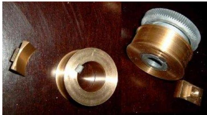
Ein Achsensatz besteht aus dem Klemmblock (die eigentliche Scheibe), einer Passfeder und einem Bremsblock. Rechts auf dem Bild der bereits aufgesetzte Block auf dem Schneckenrad.
