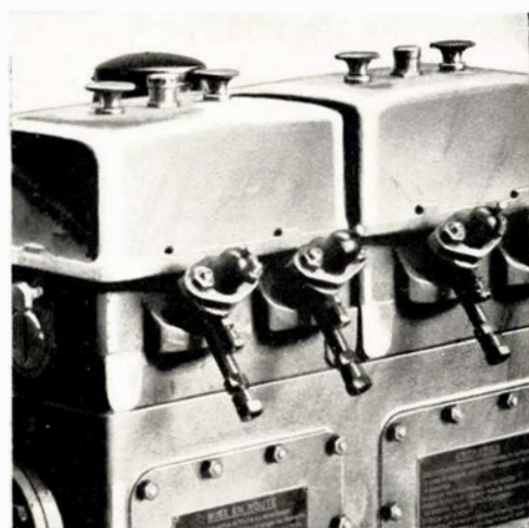
Disposition des injecteurs du moteur 12 CV 4 cyl. (La tubulure d'arrivée du gazoil n'est pas représentée.)
