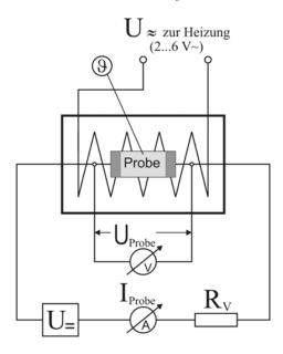
Durch die Probe fließt in Längsrichtung ein Gleichstrom. In den Stromkreis wird ein Schutzwiderstand von  $180~\Omega$  geschaltet. Stromstärke und Spannung an der Probe werden gemessen. Daraus werden der Widerstand und die spezifische Leitfähigkeit bestimmt.
