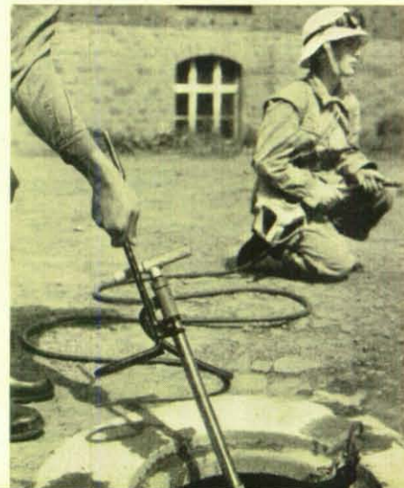
Zur direkten Löschwasserförderung ist das Rohrgestell bis zu seinem unteren Ende dicht über dem Fußaustritt in der Schelle hochzuschieben und dann festzuschrauben.
