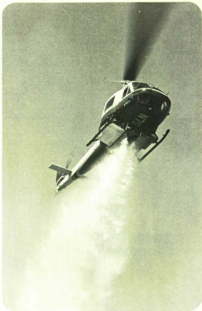
Die Hubschrauber amerikanischer Feuerwehren können das Löschwasser sowohl in Auffangbecken für Motorspritzen als auch über dem Brandherd ablassen.
