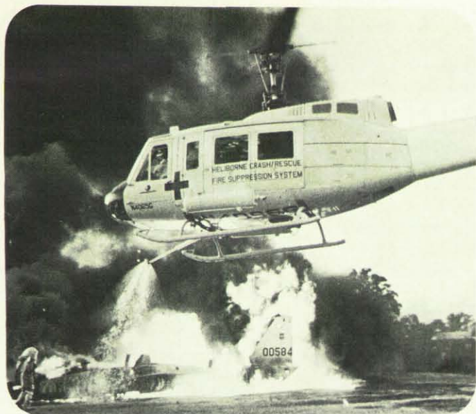
Neuentwicklung eines Feuerlösch- und Rettungshubschraubers für amerikanische Militärflugplätze. Der Löschschaum wird aus einem Teleskoprohr abgesprüht.
