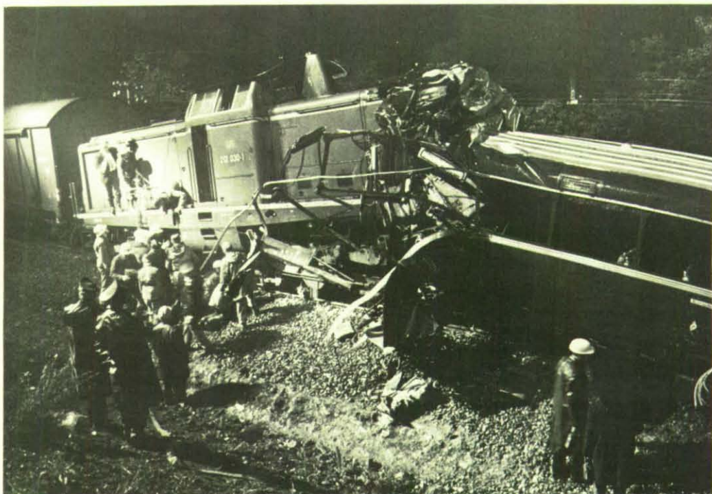
Blick auf die Unglücksstelle. Links die Diesellok des Güterzuges, rechts der Schienenbus. Die Lok hat den Triebwagen auf ein Drittel seiner Länge zusammengedrückt.
