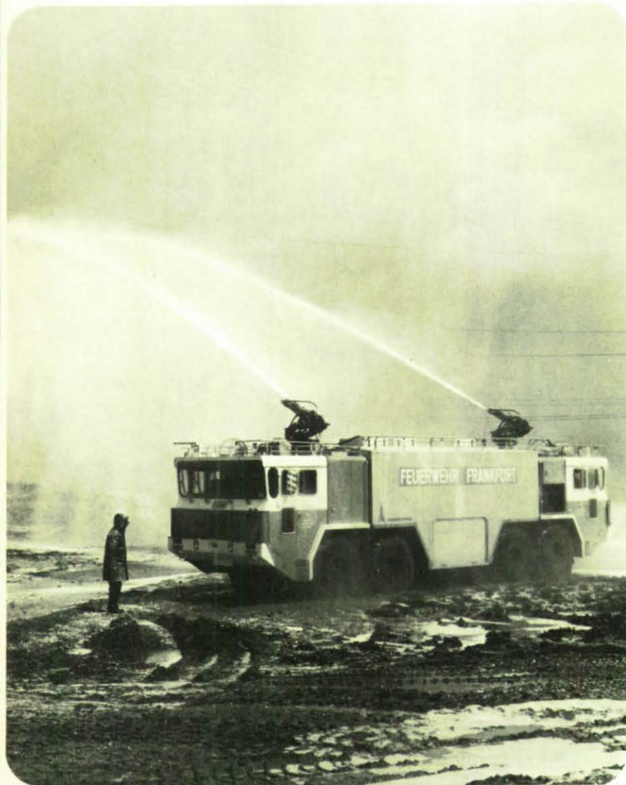
Das neue, für die Frankfurter Feuerwehr bestimmte Großtanklöschfahrzeug ist ein Beispiel für den Fortschritt auf dem Gebiet der Brandbekämpfung. Die beiden hydraulisch gesteuerten Schaum-Wasserwerfer werden vom Fahrerhaus aus bedient.
