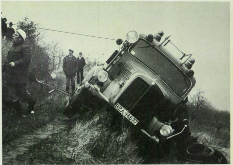
Mit Hilfe von Greifzügen und der Vorbauwinde des GKW wird das Fahrzeug wieder auf die Räder gestellt. Es entstand dabei kein Schaden.
