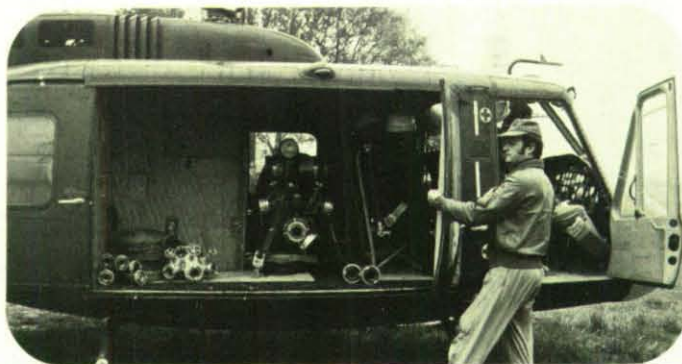
Löschgruppe der Feuerwehr Bonn mit vier Mann, einer Tragkraftspritze TS 8/8 und Zubehör in einem Hubschrauber der Luftwaffe fertig zum Start.
