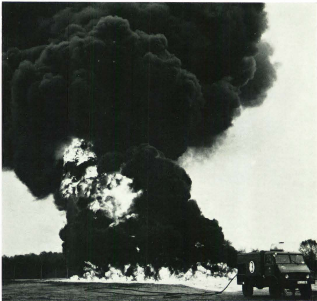
5000 Liter Flugkraftstoff brennen. Aber erst wenn das Feuer seinen Höhepunkt erreicht hat, wird die Feuerwehr eingreifen. Gemessen werden dann Löschzeit und Löschmittelmenge. Diese Aktion ist ein Teil eines Tests der DFVLR.
