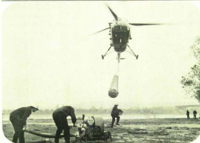
Unmittelbar nach der Landung der Löschgruppe bringt ein Hubschrauber des Landesfeuerwehrverbandes Niedersachsen Löschwasser in einem Faltbehälter per Lastennetz.
