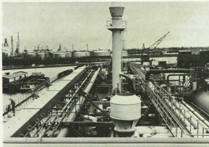
Oberdeck des Gastankers. Ein kompliziertes Brandschutzsystem sorgt dafür, daß in jedem Winkel des Schiffes bei der Entstehung eines Brandes sofort mit einem der Löschmittel Wasser, Pulver oder CO<sub>2</sub> gelöscht werden kann.
