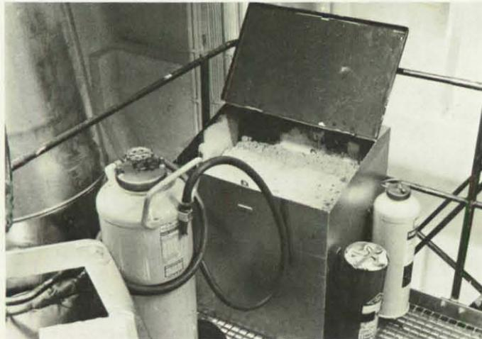
**Feuerlöschpunkt.** An besonders gefährdeten Stellen des Schiffes befinden sich Feuerlöschpunkte, die sich aus verschiedenen Handfeuerlöschern, einem Kasten mit Löschsand und aus einer Feuerlöschdecke zusammensetzen.
