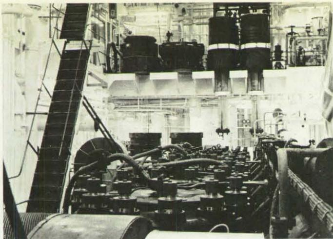
Der Maschinenraum. Einer der am meisten gefährdeten Räume, der aber auch vielfach geschützt ist. Die mannshohen Kolben und andere Teile im Hintergrund sind Ersatzteile für die 12 000 PS starke Hauptmaschine.
