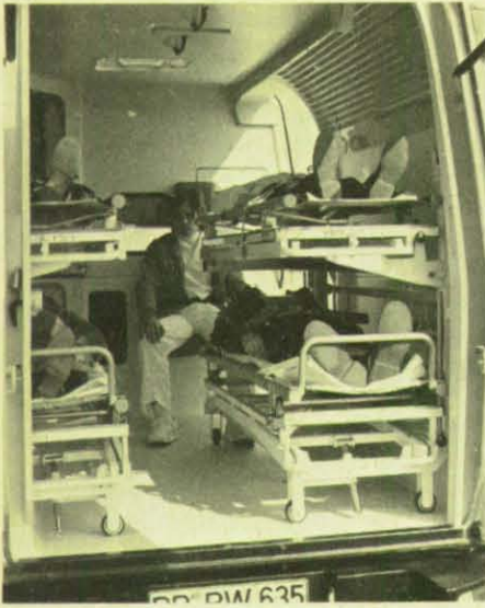
SAVE-Krankenwagen mit Vier-Tragen-Einrichtung in einem Experimentalfahrzeug.
