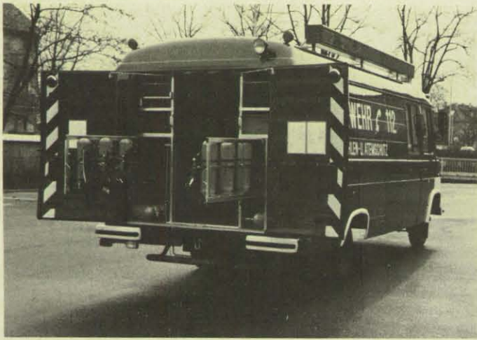
Rückfront des GW-AS mit herausgezogenen Schlitten, an denen je drei Preßluftatmer befestigt sind.
