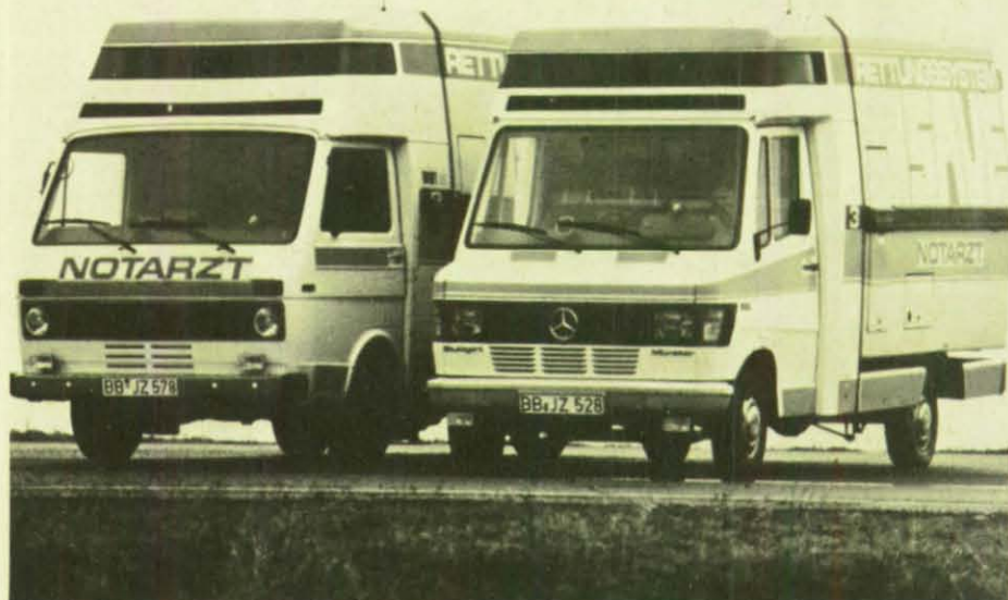
Die im Versuch eingesetzten Trägerfahrzeuge (VW LT 28 und DB 208) mit SAVE-Containeraufbau.
