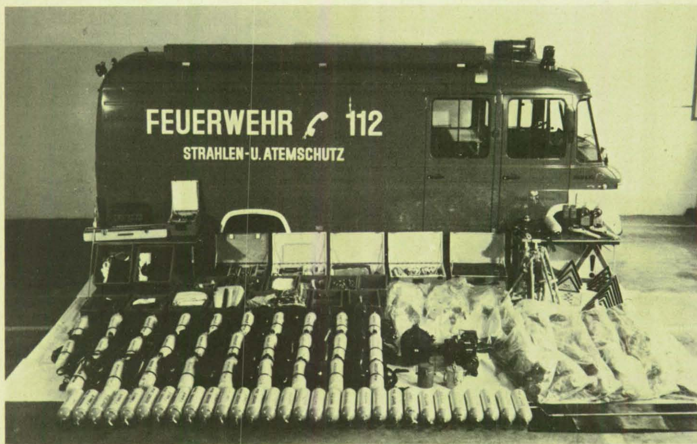
Der Gerätewagen für Atem- und Strahlenschutz (GW-AS) mit kompletter Beladung.
