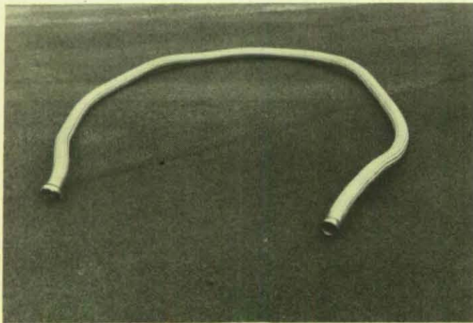
Bei der Erprobung stellte sich der Edelstahlschwellenschlauch als der am besten geeignete heraus.
