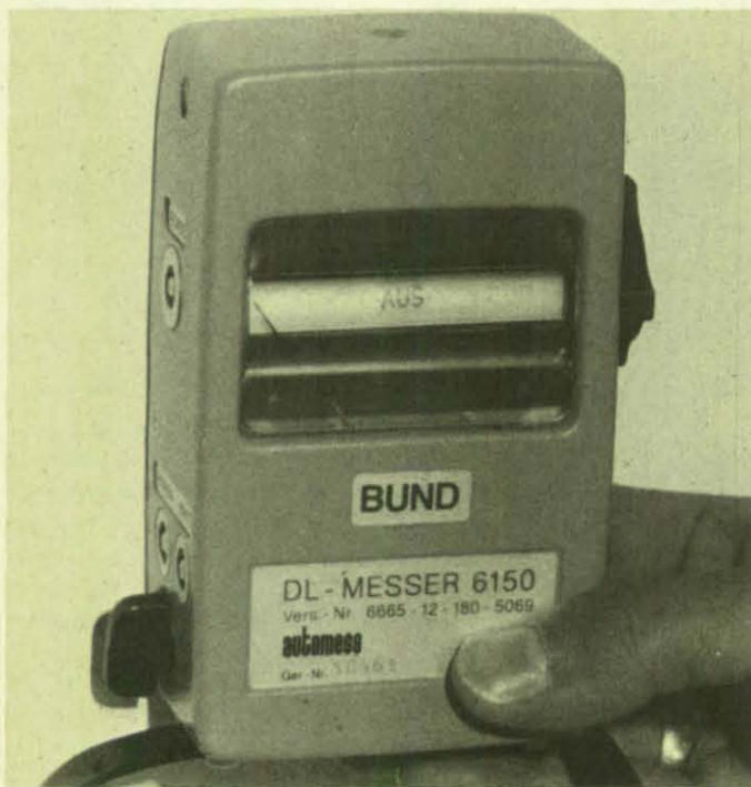
Dosisleistungsmeßgerät der ABC-Melde- und Auswertestelle (AMAST). Diese Geräte sind nur für die Messung von Gamma-Strahlen geeignet. Der Meßbereich ist beschränkt. (Fotos: Wiedemann)
