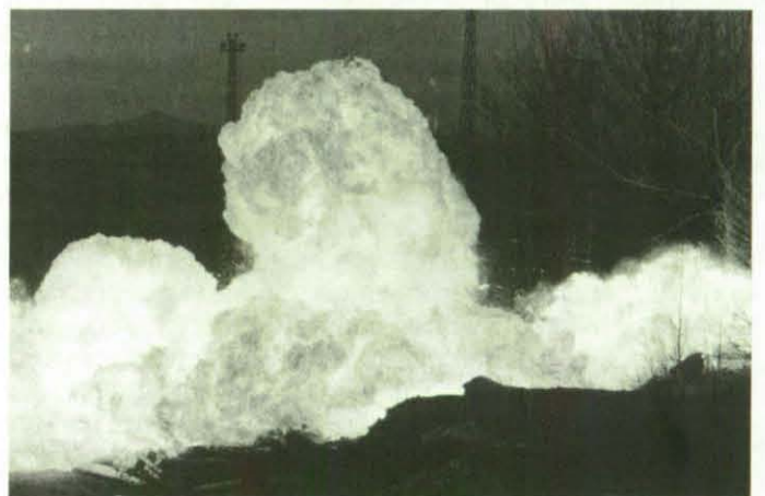
... der anschließend zur Explosion gebracht wird. So kann eine Kesselwagenexplosion dargestellt werden.
