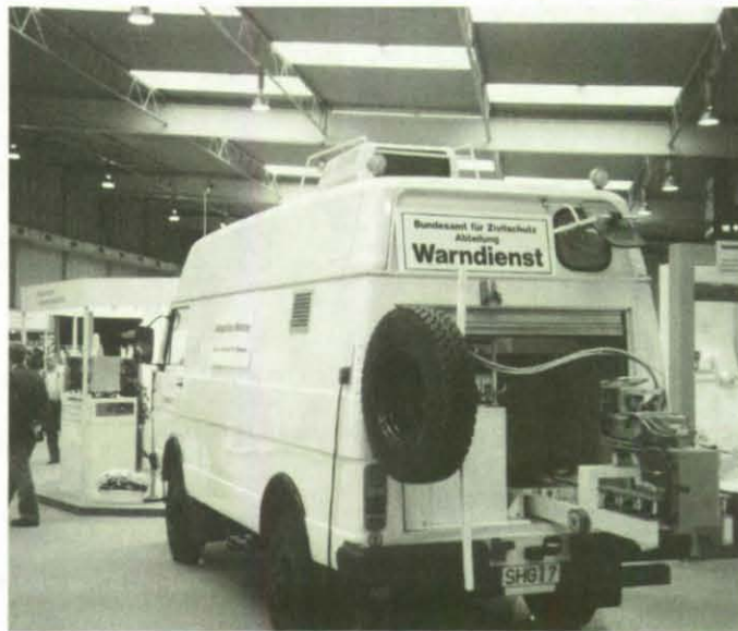
Das nuklidspezifische Meßfahrzeug des Warnamtes III.
