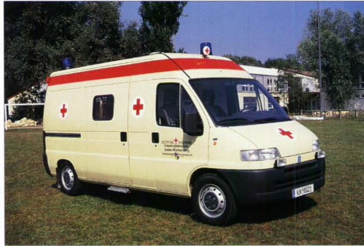
Einer der ersten Vier-Tragen-Wagen der neuen Generation: Fiat-Ducato des DRK-Kreisverbandes Konstanz. Deutlich sichtbar die Aufbauverlängerung.
