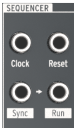
Der Sequenzer-Bereich der Patch-Bay
