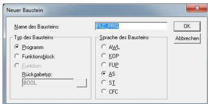
**Abbildung 34:** Anlegen des ersten Bausteins für die Steuerung im CoDeSys-Programmiersystem.
