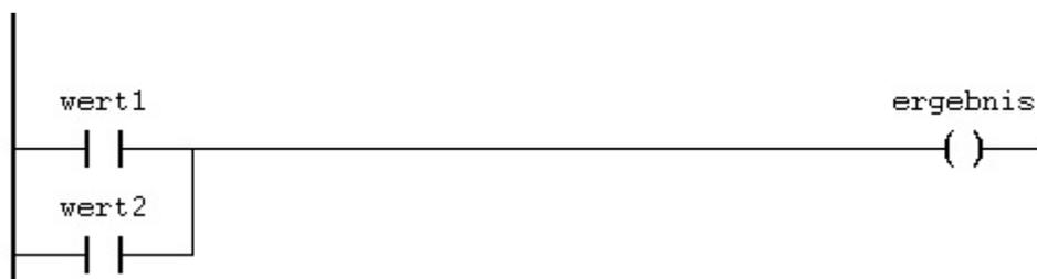
**Abbildung 26:** Ein simpler Kontaktplan (KOP) mit linker und rechter Stromschiene, den beiden Kontakten *wert1* und *wert2* sowie der Spule *ergebnis*.
