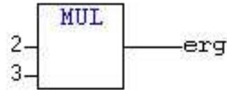
**Abbildung 28:** Ein einfaches Beispiel für die Nutzung einer Funktion in der FBS
