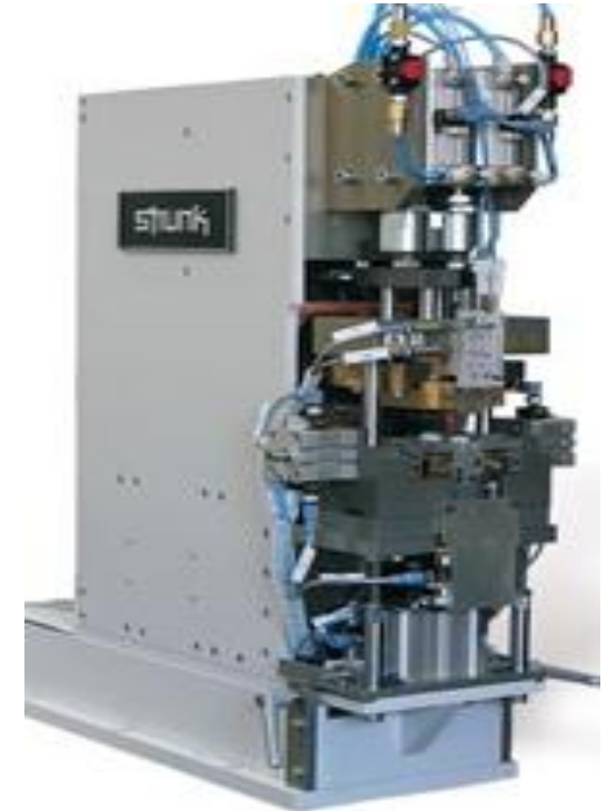
Pneumatischer Schweißkopf mit mechanischer Feder für die Nachsetzbewegung [Fa. Strunk Connect GmbH & Co. KG]
