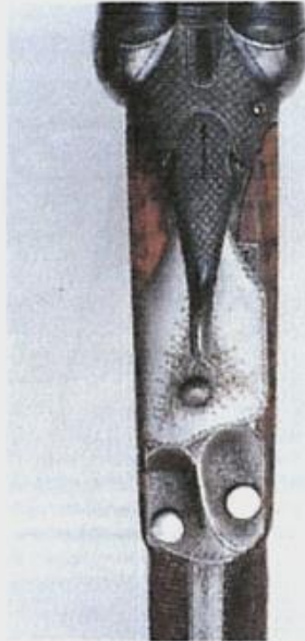
Umbau. Die beiden Knopfloslöser sind in ergonomisch geformten Mulden, die der Daumenform angepasst sind, untergebracht.
