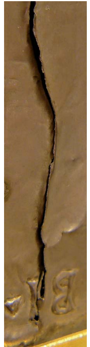
Bild 35 Koordinaten 14/18 f Riss in der Oberfläche / Crack in the surface
