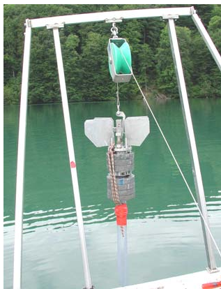
Abbildung 7: Kurzkerngerät zur Entnahme ungestörter Sedimentproben (Gerät und Foto: Gewässer- und Bodenschutzlabor des Kantons Bern)
