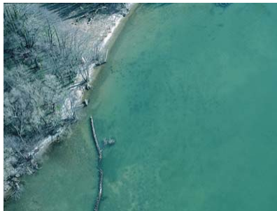
Abb. 1: Sutz-Lattrigen - Rütte. Erosionsschutzmassnahmen 1997/98. Der Bau eines Wellenbrechers war einer der ersten Massnahmen zum Schutz einer archäologischen Fundstelle am Bielersee.
