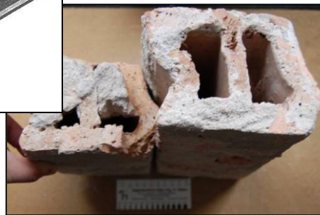
Bild 21: Ansicht Systemstein der Försterdecke
