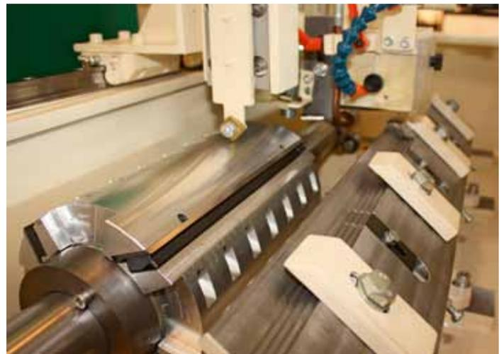
**Die gesamte Hobelwelle wird aus der Maschine genommen, die Werkzeuge werden am Messerkopf geschärft – dies ermöglicht hohe Genauigkeit**
