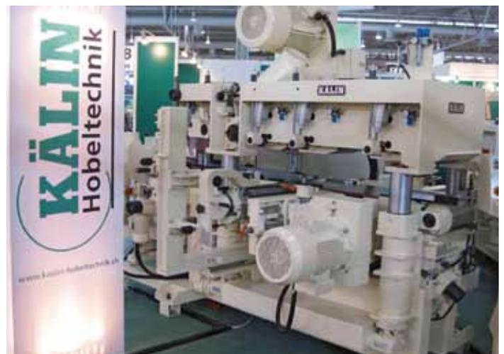
**Hochleistungshobelmaschine mit Wechselwellen** war als eine von drei ausgestellten Maschinen bei Kälin auf der Ligna zu sehen
