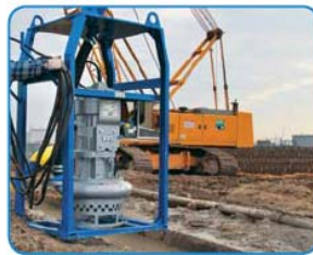
Spezialtiefbau, EL35 für Schlitzwandeinsatz
