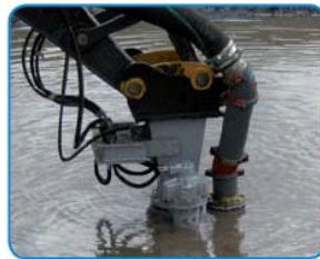
HY85B + EXHY20: Pumpen von Sandsuspension in einem Kieswerk
