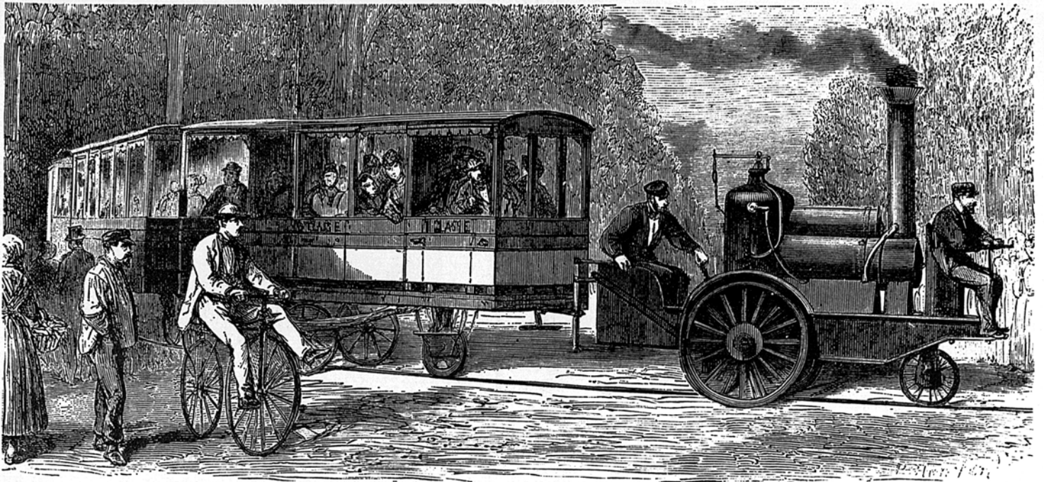
Eine unechte Einschienenbahn nach dem System Larmanjat wurde 1868 zwischen Raincy und Montfermeil in Frankreich gebaut. In der Längsachse des Fahrzeuges waren Räder angeordnet, die von einer Schiene geföhrt wurden; nebenher liefen — auf der Straßenoberfläche — Räder, die der Erhaltung des Gleichgewichts dienten.
