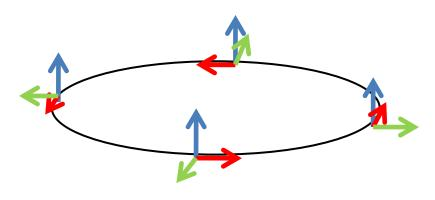
$$\begin{split} \vec{n}_1 &= \mathrm{Re}[z^t i \sigma^y \vec{\sigma} z], \\ \vec{n}_2 &= \mathrm{Im}[z^t i \sigma^y \vec{\sigma} z], \\ \vec{n}_3 &= z^\dagger \vec{\sigma} z. \end{split}$$
