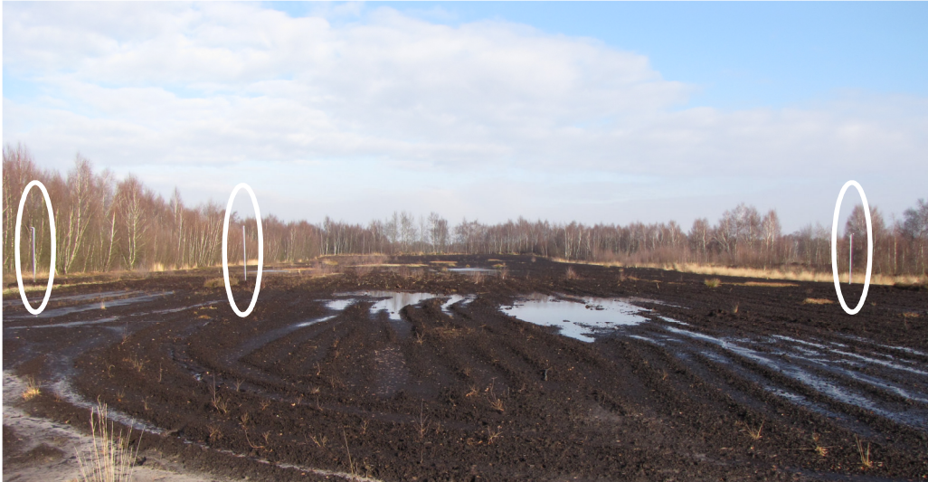
Abbildung A 30: Transektmessungen der Ammoniak-Konzentrationen in der Luft im Moorrandbereich (Wesuweer Moor) (Foto: J. Suda).
