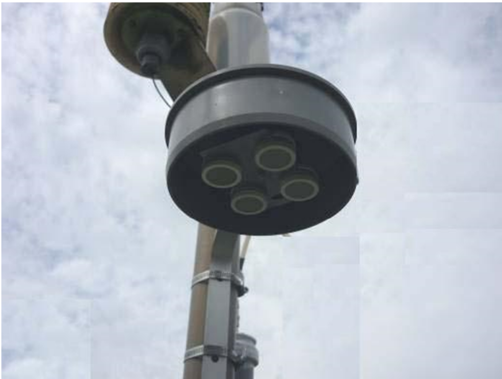
Abbildung A 29: IVL-Sammler für die Messung der Ammoniak-Konzentrationen in der Luft im Projekt ERNST (Foto: J. Suda).
