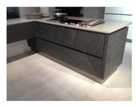
Oberflächen: Das biegsame Steinfurnier stammt aus spaltbarem Schiefergestein. Dieser wird auf einer Stärke von 0,6 mm abgespalten und einseitig auf das Trägermaterial (MDF oder Spanplatte) gebracht. Gegenzugpapier sorgt für garantierte Stabilität der Platte. Für Fronten, die in häufigem Kontakt mit Schmutz und Feuchtigkeit stehen (z.B. Küche oder Bad), kann auf Wunsch eine Versiegelung der Oberfläche erfolgen.
