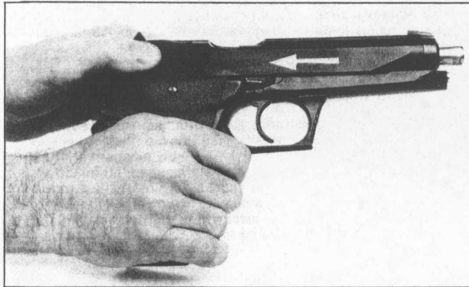
Verschluß zurückziehen Pull back the breech Tirer en arrière la culasse
