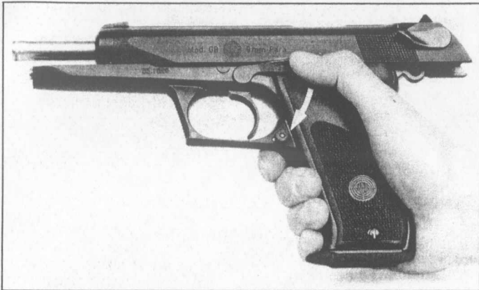
Verschlußfang betätigen depress breech catch Actionner l'arrêteur de culasse
