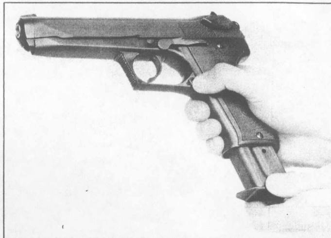
Magazin entnehmen Remove the magazine Enlever le magasin
