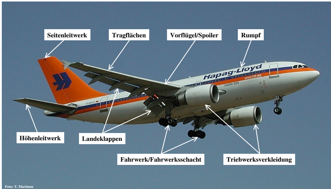
Abb. 3.4: Quellen von Umströmungsgeräuschen
