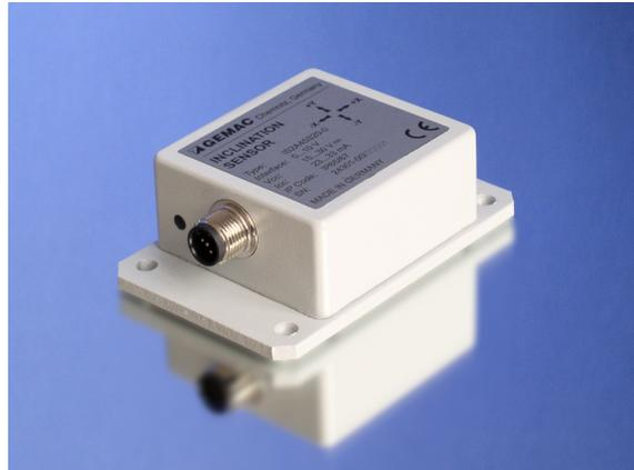
Der Neigungssensor IS1A xx P18 dient, je nach Ausführung, zum einkanaligen Messen von Neigungen in den Bereichen  $\pm 10^\circ$ ,  $\pm 45^\circ$  oder  $\pm 60^\circ$ . Der Neigungssensor IS2A xx P18 enthält zwei Kanäle. Die Messbereichsendwerte sind bei  $25^\circ\text{C}$  werkseitig kalibriert.
