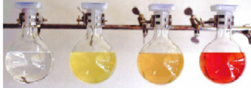
CdSe-Nanopartikel in Lösung (1,5 - 4,0 nm)
