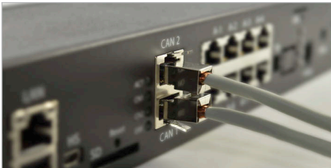
Abb.: Jedes Zertico Überwachungssystem ist mit 2 CAN-Bus Ports ausgestattet. An jedem einzelnen CAN-Bus können per Plug 'n' Play bis zu 8 CAN-Sensoren / CAN-Units angeschlossen werden.
