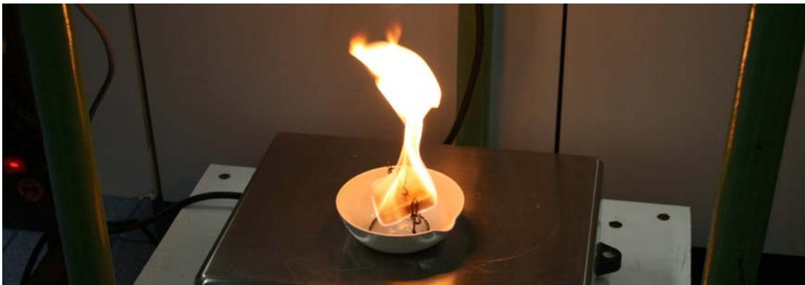
**Abbildung 26:** Vollständiges Verbrennen (Phase II)
