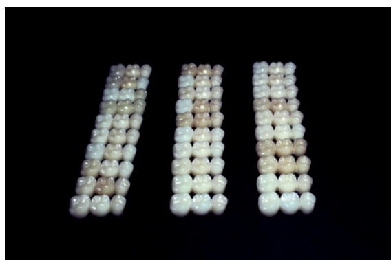
Abb. 5: Brückenserien für die Dauerschwingprüfung nach DIN Norm 50100.
