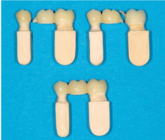
Abb. 7a: Infix-Brücken nach der Belastungsprüfung in der Seitenansicht. Bei den statischen und dynamischen Belastungsprüfungen traten in den Verbinderbereichen nur Gerüstfrakturen auf (obere Brücken). Bei den Dauerschwingprüfungen mit einer Belastung von 55 % der mittleren maximalen Bruchlast wurden weder Gerüst- noch Verblendungsfrakturen beobachtet (untere Brücken).
