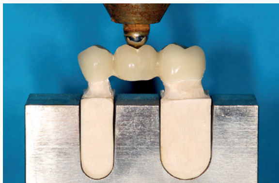
Abb. 4: Prüfanordnung für eine axiale Belastungsprüfung. Die Metallstümpfe 15 und 17 wurden dupliert und aus einem Kunststoff mit einem zum Dentin vergleichbaren Elastizitätsmodul ersetzt.
