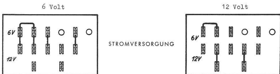
Umschaltung durch Umsetzen der Lötbrücken
