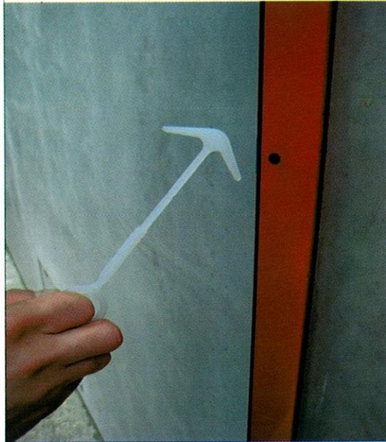
3 Drehen + Ziehen des FLUXX-Ankers
