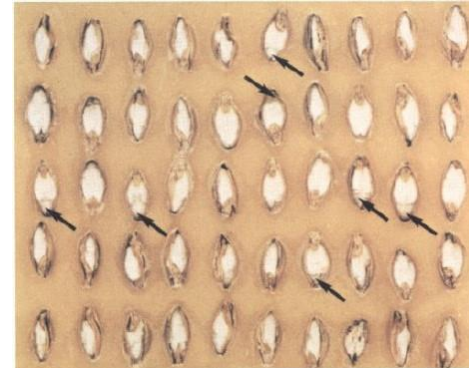
Malzkörner abgeschliffen vor der Calcofluorfärbung
