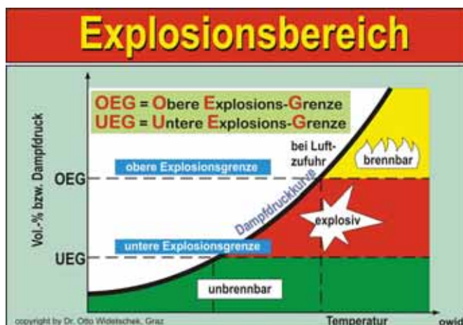
Obere und untere Zündgrenze anhand der Dampfdruckkurve schematisch dargestellt).
