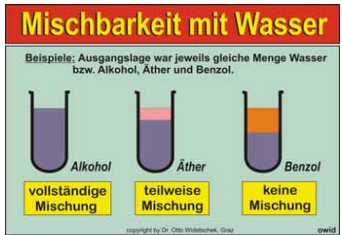
Die Mischbarkeit von brennbaren Flüssigkeiten mit Wasser (schematisch).
