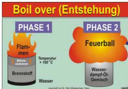
Die Entstehung eines „boil overs“ (schematisch).
