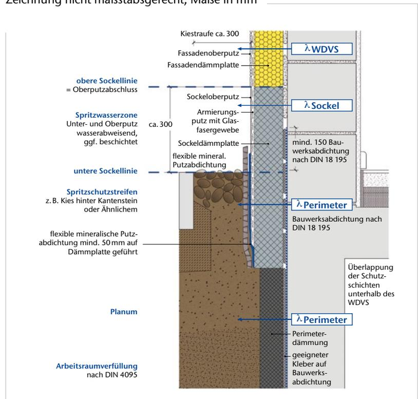
Abstand von der Wärmedämmung einhalten. Die Perimeter-Perimeterdämmplatten müssen einlagig, dichtgestoßen im Verband verlegt werden und eben auf dem Untergrund aufliegen. Kreuzstöße sind zu vermeiden. Im Anwendungsbereich unter einem Kellerfußboden sind die Platten nach dem Verlegen durch eine Folie (z. B. eine Polyethylen-(PE)-Folie) zu schützen. Der Einbau unter lastabtragenden Bauteilen ist nicht zulässig.
