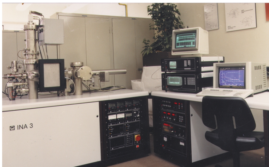
Abb. 13: Sekundär-Neutralteilchen-Massenspektrometer für die Analyse von unbeschichteten und beschichteten Fein- und Feinstblechoberflächen.
