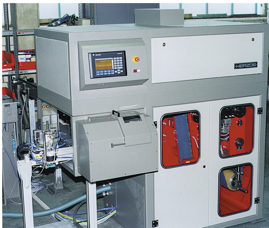
Abb.10: Moderner Fräs- und Schleifautomat für die Vorbereitung von Stahlproben (Typ HBF 4000). (Mit freundlicher Genehmigung der Herzog Maschinenfabrik GmbH & Co., Osnabrück).
