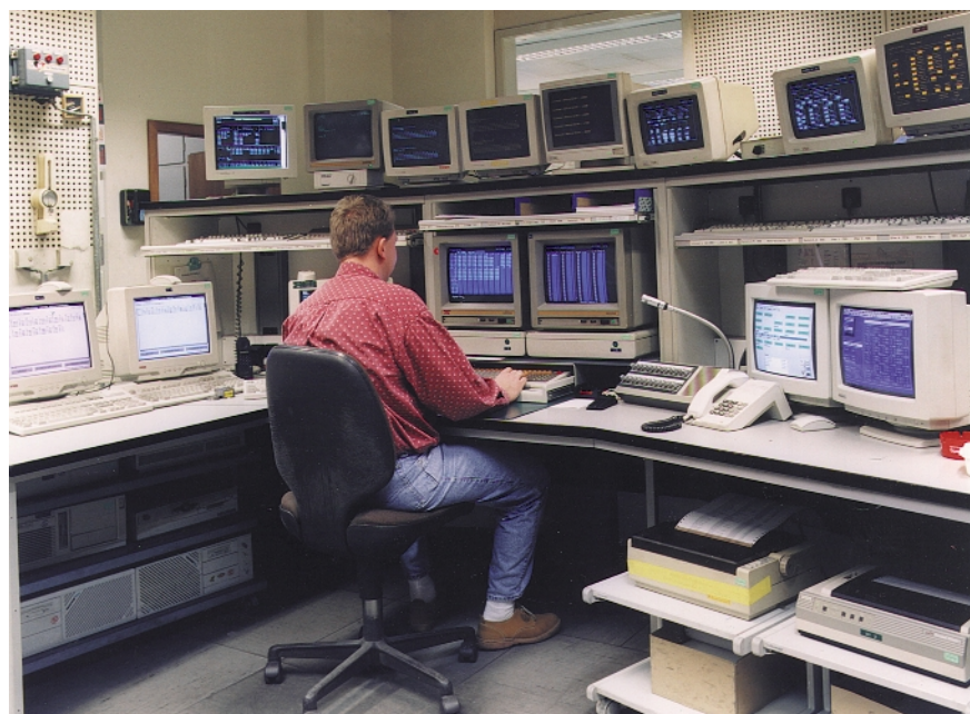
Abb. 8: Operator-Arbeitsplatz in einem automatisierten Stahlwerkslaboratorium, von dem aus sämtliche analytischen Arbeitsvorgänge überwacht werden, an dem alle Störungsmeldungen auflaufen und der in ständigem multikommunikativem Kontakt mit den Schmelzbetrieben steht.
