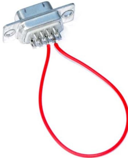
**Abb. 15** Ein Praxistip zwischendurch: Welches Kabel gehört zu welchem COM-Port? Das kann man mit einem Kurzschlußstecker experimentell herausfinden. Die Signale TX und RX (Pins 2 und 3) sind hier miteinander verbunden (echte Profis schaffen es auch mit einem Schraubenzieher oder einer aufgebogenen Büroklammer...). Gehört das Kabel zum ausgewählten COM-Port, werden Tastatureingaben auf dem Terminalfenster angezeigt (Echofunktion). Kurzschlußstecker kann bei Bedarf ausgeliehen werden.
