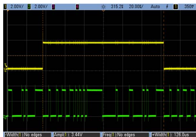
Abb. 36 Lineares rückgekoppeltes Schieberegister (LFSR). 8 Bits, verringerte Zykluslänge.
