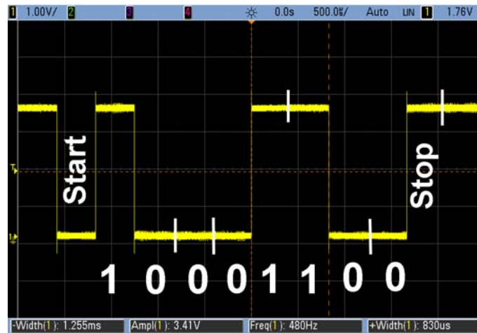
Abb. 34 Zeichen 31H = 0011 0001. Übertragungsreihenfolge 1000 1100.
